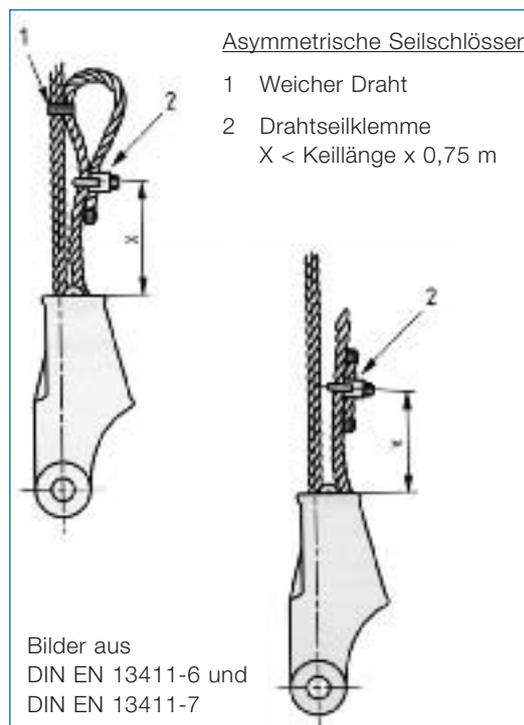
Seilschlösser sind nur auf Zug zu beanspruchen und sind gegen unbeabsichtigtes Lösen zu sichern. Das nicht tragende Seilende wird hierzu mit einer Seilklemme fixiert. Bei asym-
