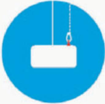
**Befestigungspunkt für Sicherungsdrahtseil**
