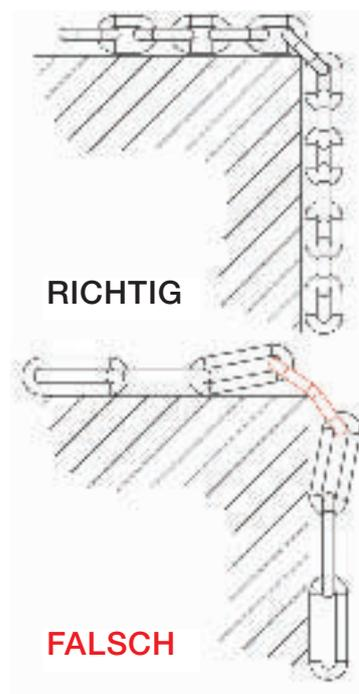
Für die Anpassung der Kettenlänge werden Kettenverkürzer in unterschiedlichen Bauarten angeboten. Für die richtige Benutzung ist es besonders wichtig, die Benutzerinformationen zu beachten. Kettenverkürzer dürfen nur in der bestimmungsgemäßen Gebrauchslage verwendet werden.
