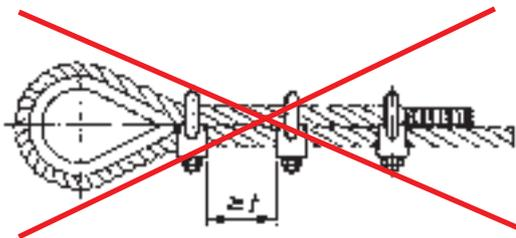
**Drahtseilklemmen für Seilendverbindungen nach DIN 1142 oder DIN EN 13411-5 dürfen nicht verwendet werden!**
